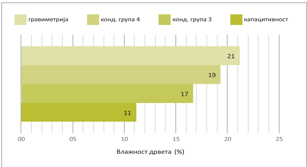
Слика 4. Измерене влажности субфосилне грађе храста у зависности од начина мерења (капацитивност - мерење контактним влагомером при корекцији за густину 0,65 \text{ g/cm}^3 ; конд. група 3 – мерење убодним влагомером при корекцији на групу 3 и конд. група 4 – мерење убодним влагомером при корекцији на групу 4)
