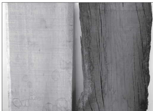
Слика 3. Разлика у боји и велико присуство пукотина на грађи субфосилног дрвета храста (лево), у поређењу са грађом уобичајеног хрastoвог дрвета (десно)
