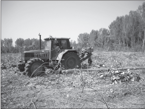
Слика 1. Трактор „Same Laser 150“ са иверачем „Rotor S“
