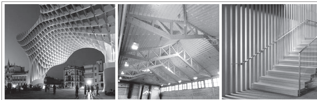
Слика 1. лево: Конструкција Метропол Парасол, потпуно израђена од LVL-а ( www.architectureanddesign.com.au ); средина: Конструкција крова са великим распонем израђена од LVL греда ( www.hochstrate.de ); десно: Примена LVL-а као неконструктивног елемента ( www.pinterest.com )
