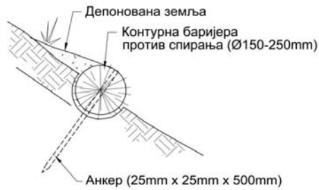
Слика 10 Контурни стабилизатори (баријере) за контролу брзог површинског отицаја (ски-стаза „Коњарник 1“, јуни 2009)
