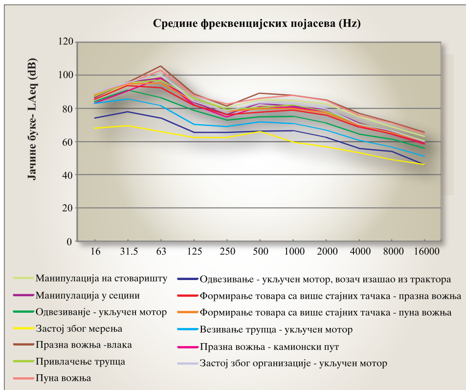
Графикон 1. Фреквенцијска анализа буке када је мотор трактора укључен Diagram 1. Frequency analysis of noise when the tractor engine is running
