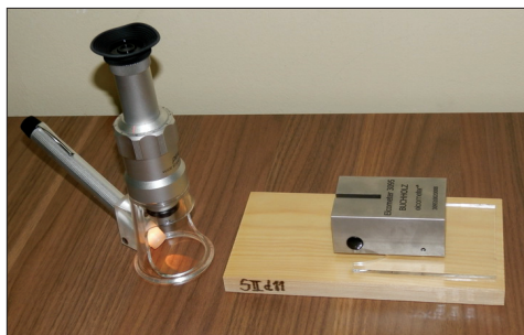
Слика 1. Одређивање утискујуће тврдоће лакираних узорака по Buchholz -у Figure 1. Determination of the indentation hardness of lacquered samples acc. Buchholz
