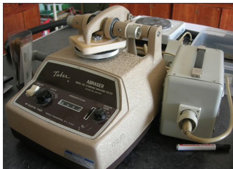
Слика 3. Инструмент за одређивање отпорности на абразију лакираних узорака Figure 3. The instrument for determination of the abrasion resistance of lacquered samples
