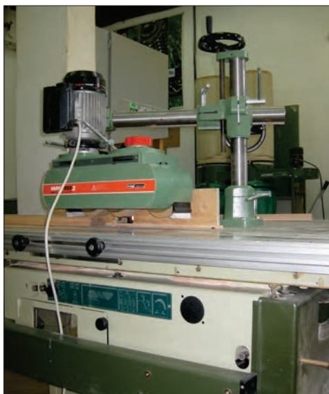
Слика 1. Уређај за помоћно кретање на станој глодалици
