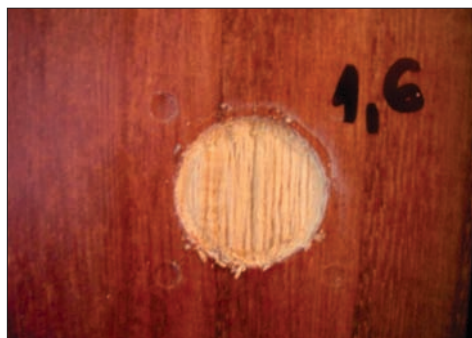
Слика 2. Лом у дрвету после урађеног теста за одређивање адхезије методом печатника
