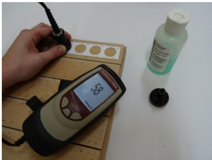
Slika 47. Merenje debljine suvog filma premaza metodom ultrazvučnog merača
