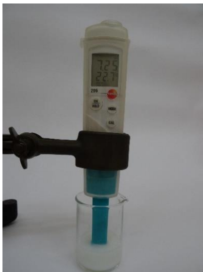
Slika 41. Merenje pH vrednosti VTA premaza
