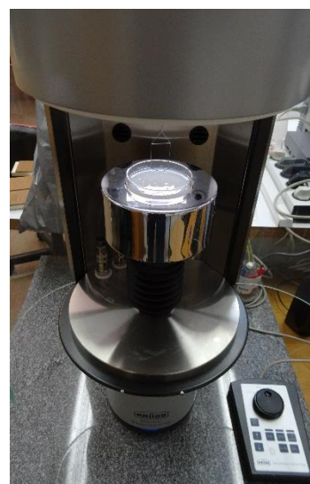
Slika 40. Postupak određivanja površinskog napona tečnog premaza: a) faze pozicije prstena tokom merenja ( http://www.bioline.com/attension/applications/?card=AA17 ); b) izgled instrumenta sa postavljenim uzorkom
