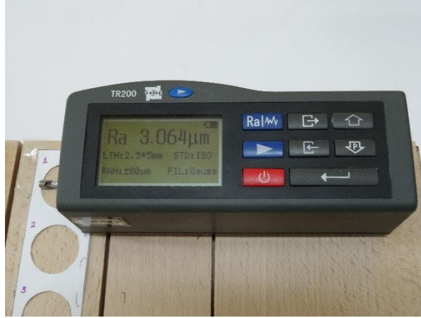
Slika 34. Merenje parametra hrapavosti površine nakon brušenja
