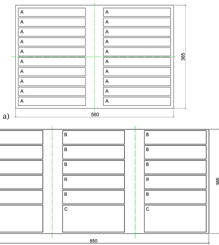
Slika 30. Shemski prikaz uzoraka zalepljenih na površinu ploče za: a) analizu svojstava drveta i uticaja tretmana; b) analizu svojstava drveta pre i nakon tretmana i svojstava očvrstnalog filma premaza (oznake A, B i C odgovaraju dimenzijama uzoraka iz table 3)
