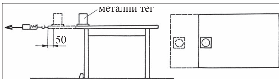
Слика 8. Испитивање стабилности стола Figure 8. Table stability
