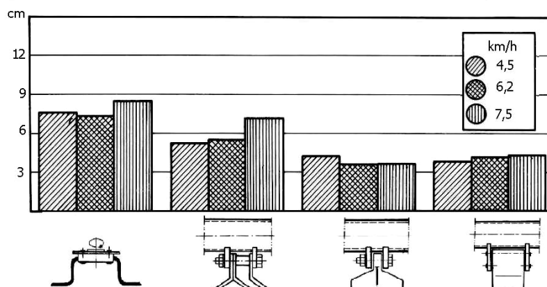
Sl. 2. Zavisnost dužine usitnjenog materijal po kolotragu točkova traktora od tipa radnog elementa i brzine kretanja agregata
