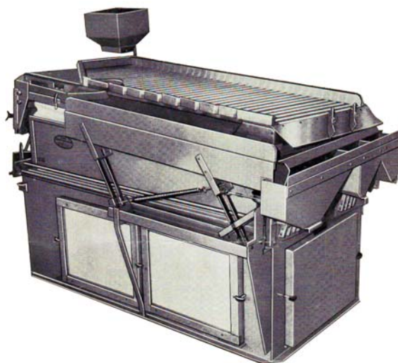
Slika 1. Gravitacioni separator – OLIVER 240 (Emceka Gompper)
