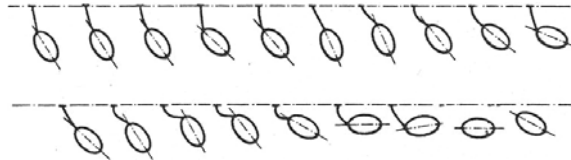
Sl. 3. Različiti položaj ploda pri frekvenciji kada je došlo do otkidanja
