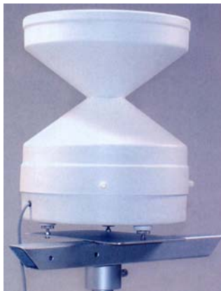
Sl. 1. Merač visine vodenog taloga (kišomer)
