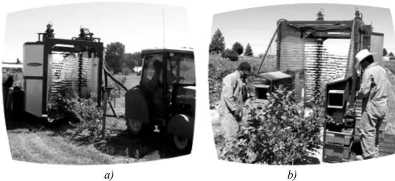
Sl. 8. Mašina za branje malina i borovnica "Korvan" 930 a) prednji izgled i priključivanje za traktor; b) zadnji izgled
