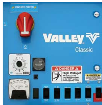
Sl. 4. Kontrolna kutija sa "procentualnim programatorom"
