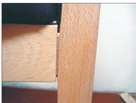
Слика 5. Оштећења на споју бочни сарг задња нога код узорака групе Б
