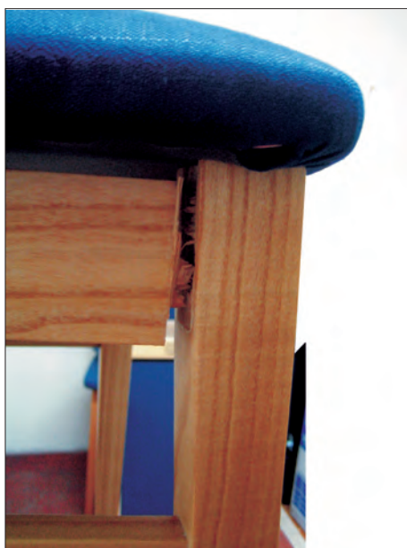
Слика 2. Оштећења на споју бочни сарг предња нога
