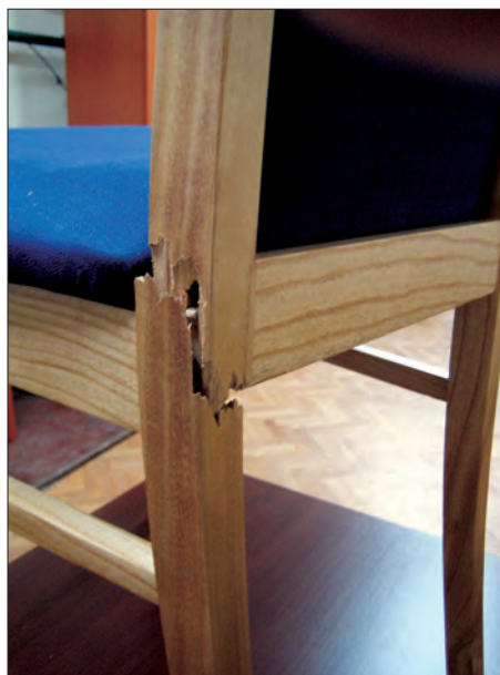
Слика 4. Оштећења на споју бочни сарг-задња нога
