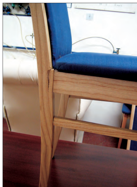
Слика 3. Оштећења на споју бочни сарг задња нога
