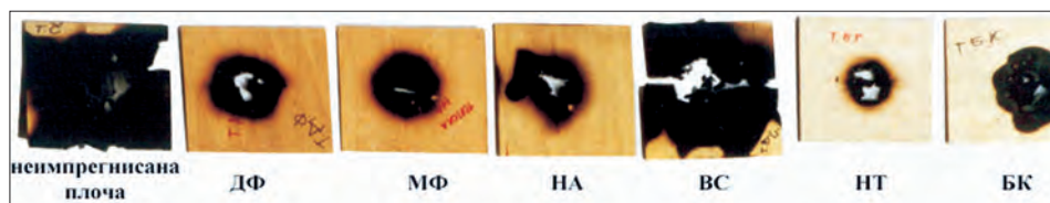
Слика 14. Изглед узорака тополових третираних и нетретиране фурнирске плоче после испитивања отпорности на дејство ватре
