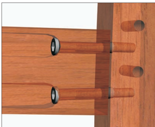
Слика 3. Спој бочни сарг-задња нога помоћу два вијка
