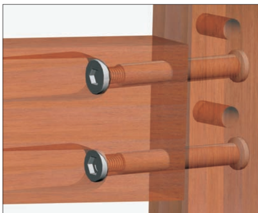
Слика 4. Спој бочни сарг - задња нога помоћу два спојна вијка
