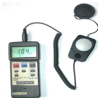
Slika 2: luksometar marke LX – 107 Lutron
