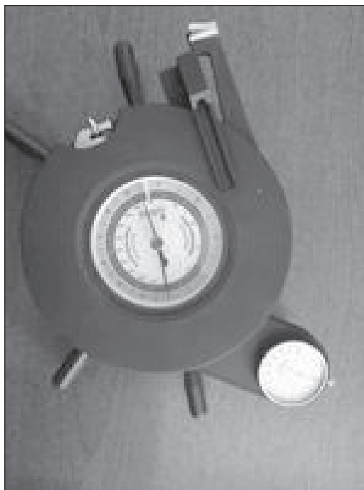
Слика 1. Фрактометар (IML Fractometer II) - уређај за мерење својстава извртака
