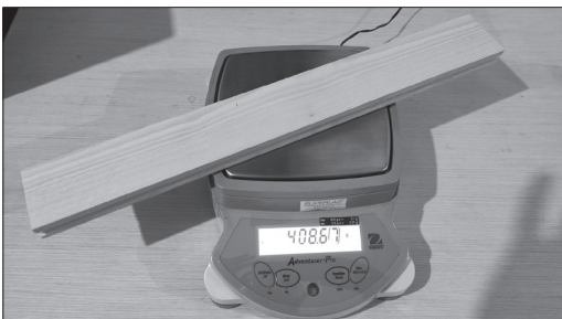
Слика 2. Мерење масе паркетне дашчице јасена
