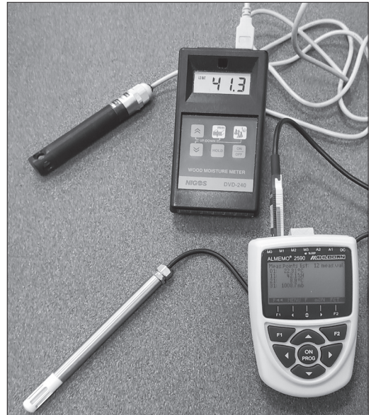
Слика 3. Капацитивне сонде за мерење температуре и релативне влажности ваздуха
