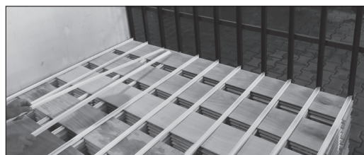
Слика 1. Слагање храстових ламела на пластичне летвице (Н профила)
