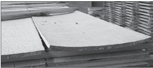
Слика 6. Коритавост ламеле из последњег реда сложаја
